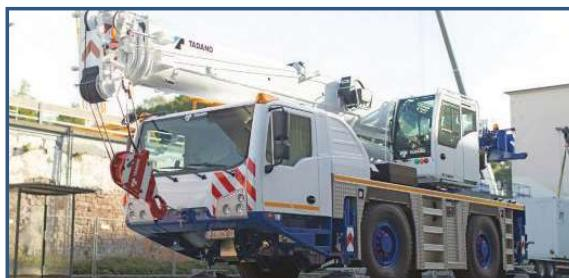
جرثقیل تمام زمینی مدل ۱۲۰۴۰ AC ۱۶۷۵۵ پوند را در طول بوم کامل ۱۱۵.۵ فوتی خود در شامع ۲۶.۳ فوت بلند کند. ظرفیت بالابر ۷۰۳۷۲ پوند است. ته بازوی ۲۹.۵ فوتی را می توان تا ۴۰ درجه جبران کرد. سیستم کنترل ۱ IC PLUS دارای تشخیص خودکار وزنه تعادل، رادار ظرفیت و نمایشگر محل کار است. این سیستم ظرفیت بالابری را برای هر موقعیت بوم به عنوان تابعی از زاویه چرخش روپتا تعیین می کند.
